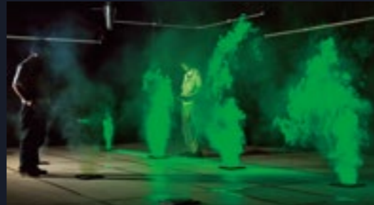
床吹出口試験
